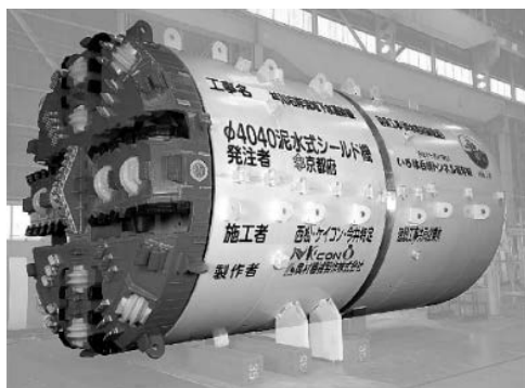
写真-1 泥水式シールド機 (φ 4,040 mm)
