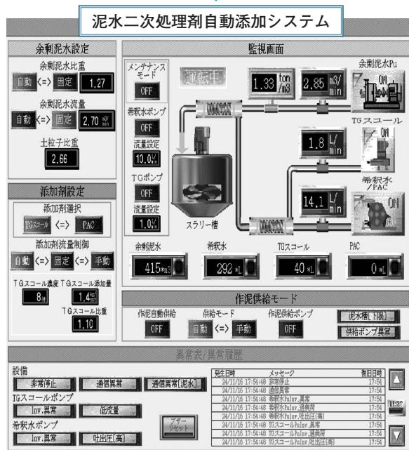
写真-3 泥水二次処理剤自動添加システム操作モニタ
