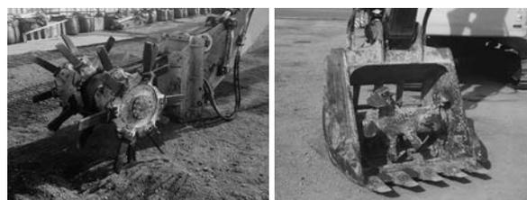
写真-2 バックホウ先端の混合装置
