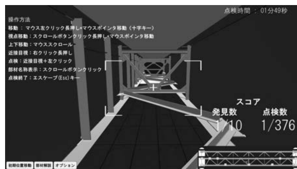
図－1 点検訓練シミュレーター
