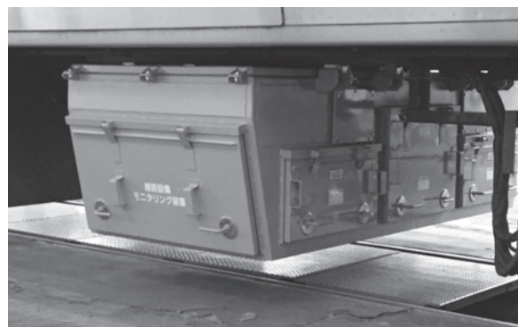
写真－4 軌道材料モニタリング装置
