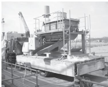
写真-4 車載式ミキサによる製造
