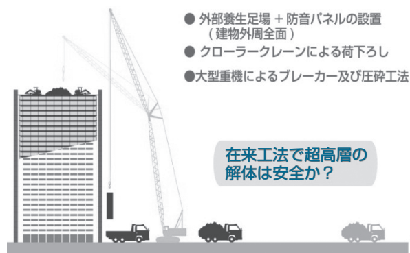
図－2 在来の解体方法の概要
