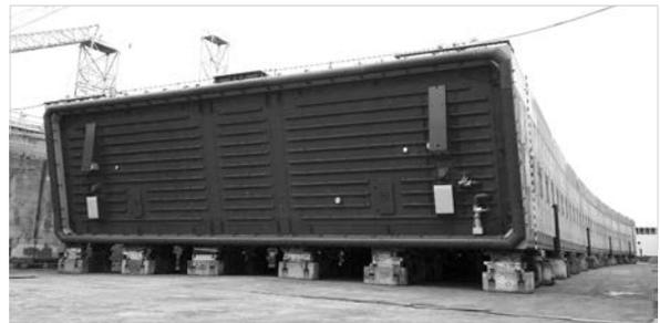
写真-5 6号函鋼殻製作完了
