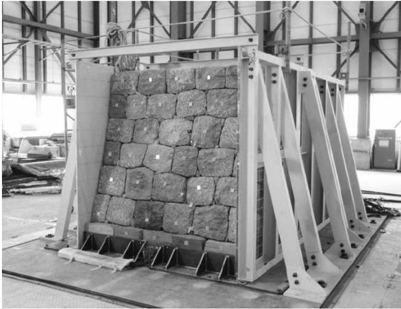
写真－6 実物大伝統的の石垣モデル振動実験の状況
