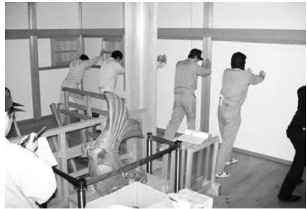
写真-4 人力加振実験の様子
