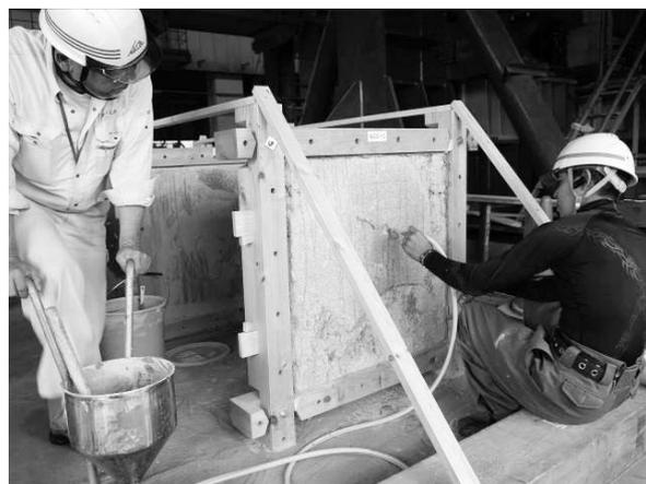
写真-5 損傷させた塗り土壁の注入補修
