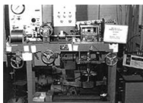
写真-1 一面せん断試験 写真-2 遠心模型実験
