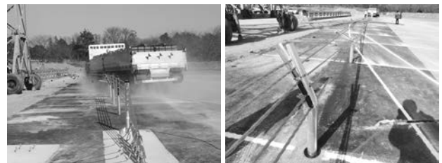
写真-3 性能確認試験（左：衝突時，右：破損状況）
