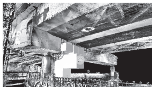
図-8 設計シミュレーション (補強時の部材配置検討)
