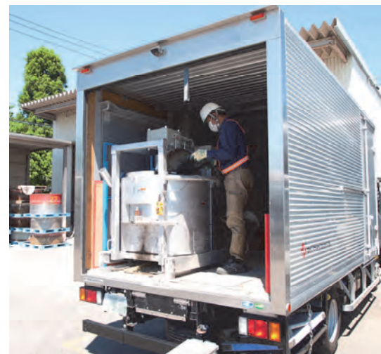
写真ー2 「ERミキサー」を積載し材料の運搬・製造機能をパッケージ化した専用プラント車
