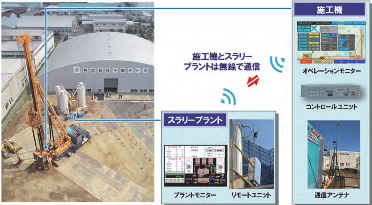
図一1 GeoPilot-AutoPile のシステム概要
