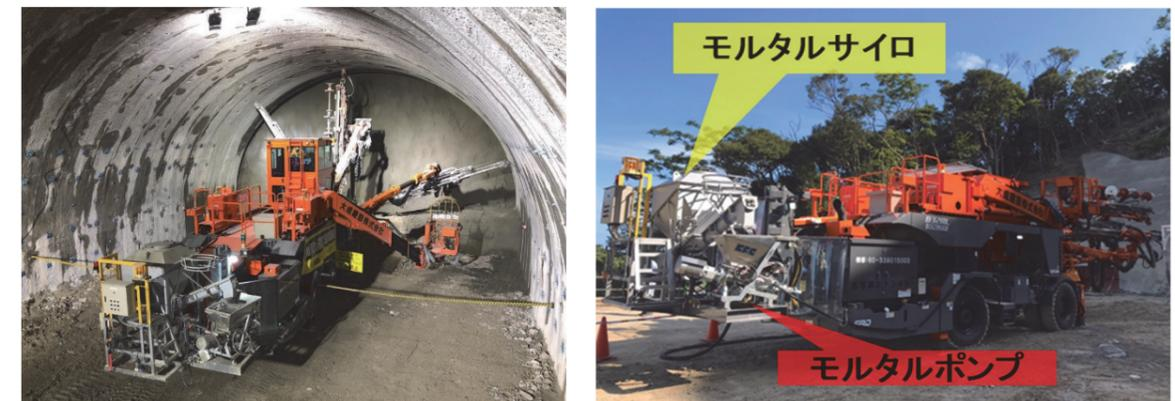
図-4 モルタル供給装置を一体化
