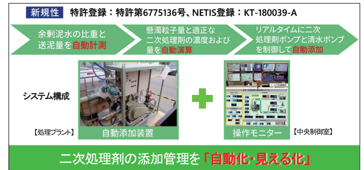
図－2 泥水二次処理剤自動添加システム
