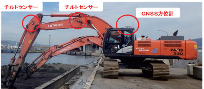
写真-1 カルシア混合用バックホウ
