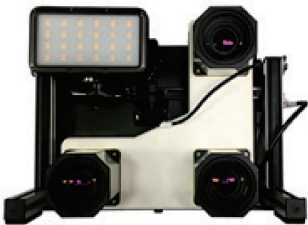
写真－3 配筋システム外観
