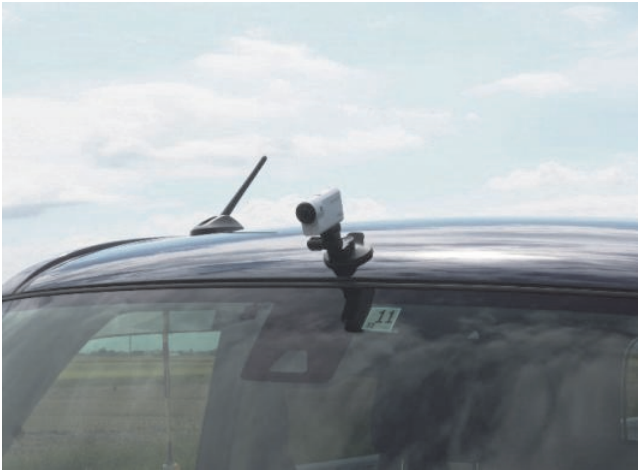
写真-1 点検機材 (市販ビデオカメラ)
