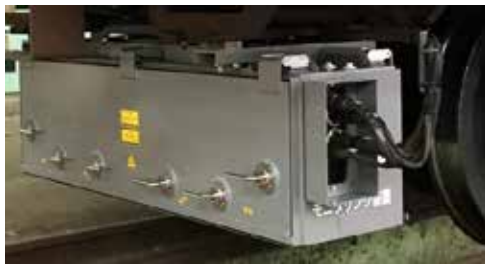
軌道変位モニタリング装置
