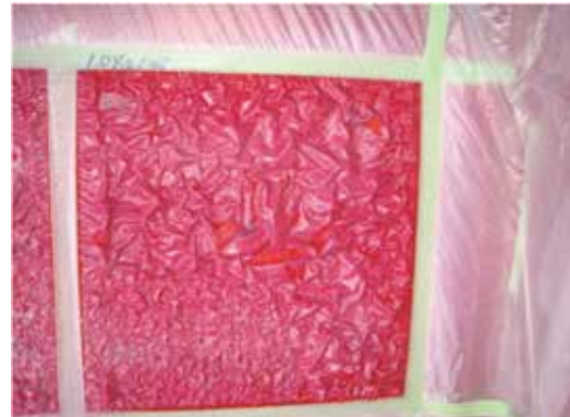
写真-2 塗膜の軟化
