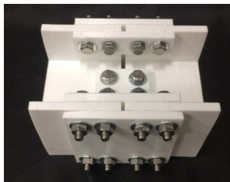
写真-4 高力ボルト摩擦接合
