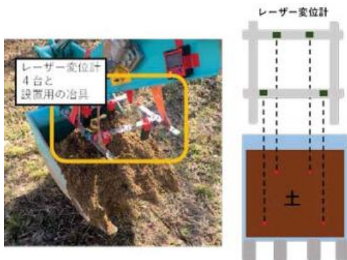
図 11 レーザー変位計による土砂の体積測定
