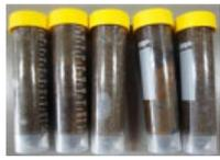
土質試料は海岸域の各地点から滅菌済みの遠沈管に採取
