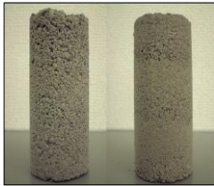
脱枠直後の供試体の外観 (左: Op50, 右: Op30, 外径5cm×高さ10cm)
