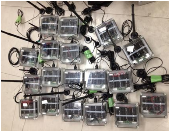
図 6 無線センサノード用ケーシングと通信アンテナ
