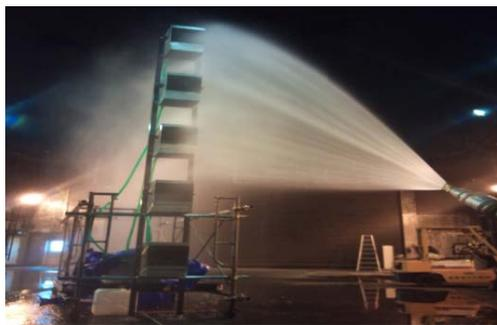
図4：散水量測定実験
