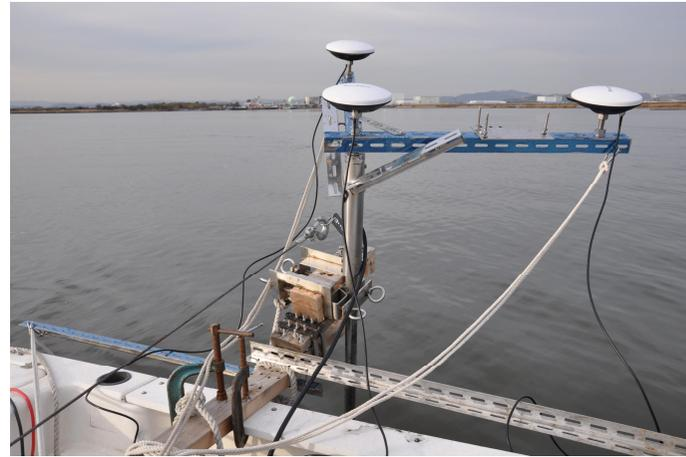
写真3：ウインチによる巻き取り解放時の支柱と（d）ウインチ巻き取り時の支柱とGNSSアンテナ，令和6年12月20日，児島湖にて
