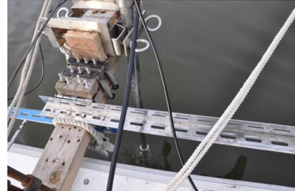
(b) 水中の下端に音響測深機送受波器が取り付けられた支柱, 令和6年12月20日児島湖にて
