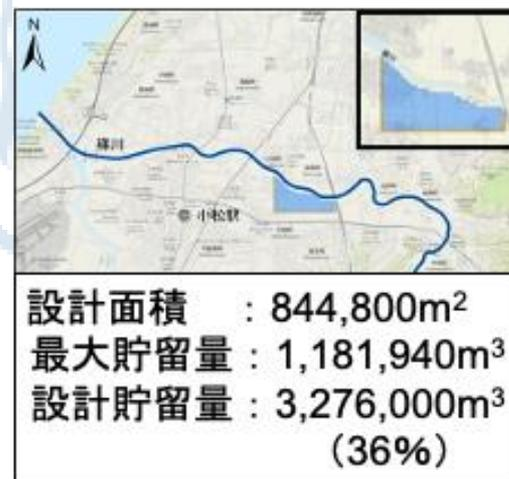
いずれも遊歩道高6.0m，遊水地地盤高1.5m，越流堤高さ5.0m
