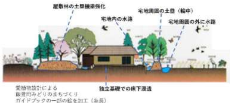
図 18 水系散居集落の伝統的構造を生かした防水・免浸の工夫
