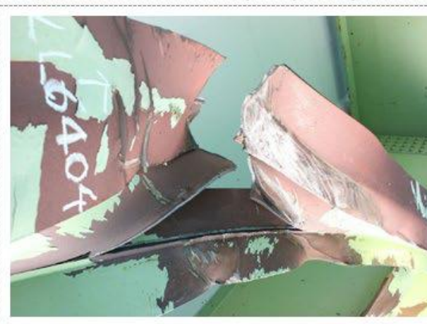
(g) 下横構破断部 ←
