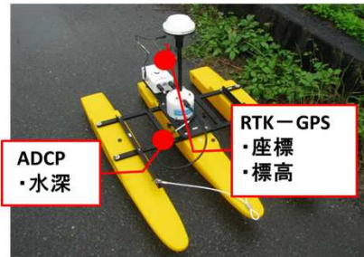
観測機材(ADCPとRTK-GPS)
