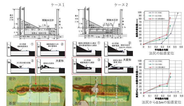
高さ1m程度の堤防で平均動水勾配0.25のとき15~20mm程度
