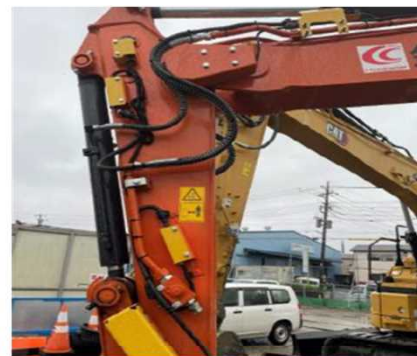
後付けICTシステムでICT建機化
