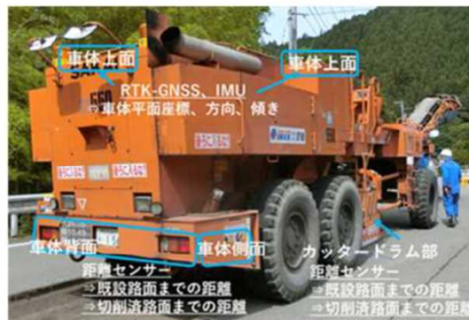
後付け装置による切削機ICT化の方法
