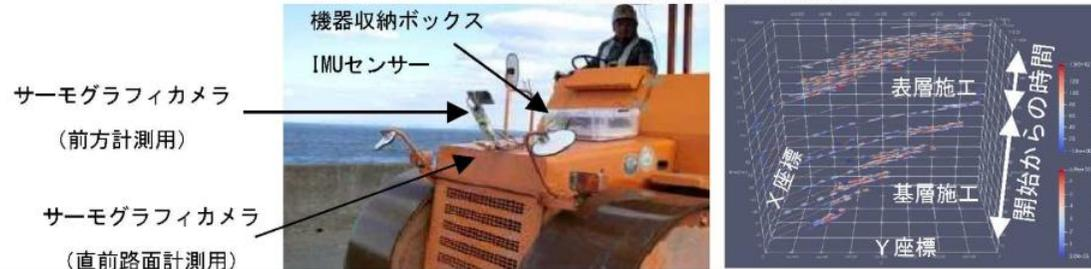
図7 施工管理及び出来形計測等の効率化に資する技術の例
