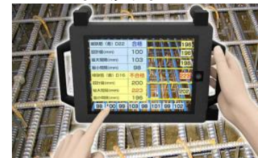
清水建設 リアルタイム自動配筋検査システム
