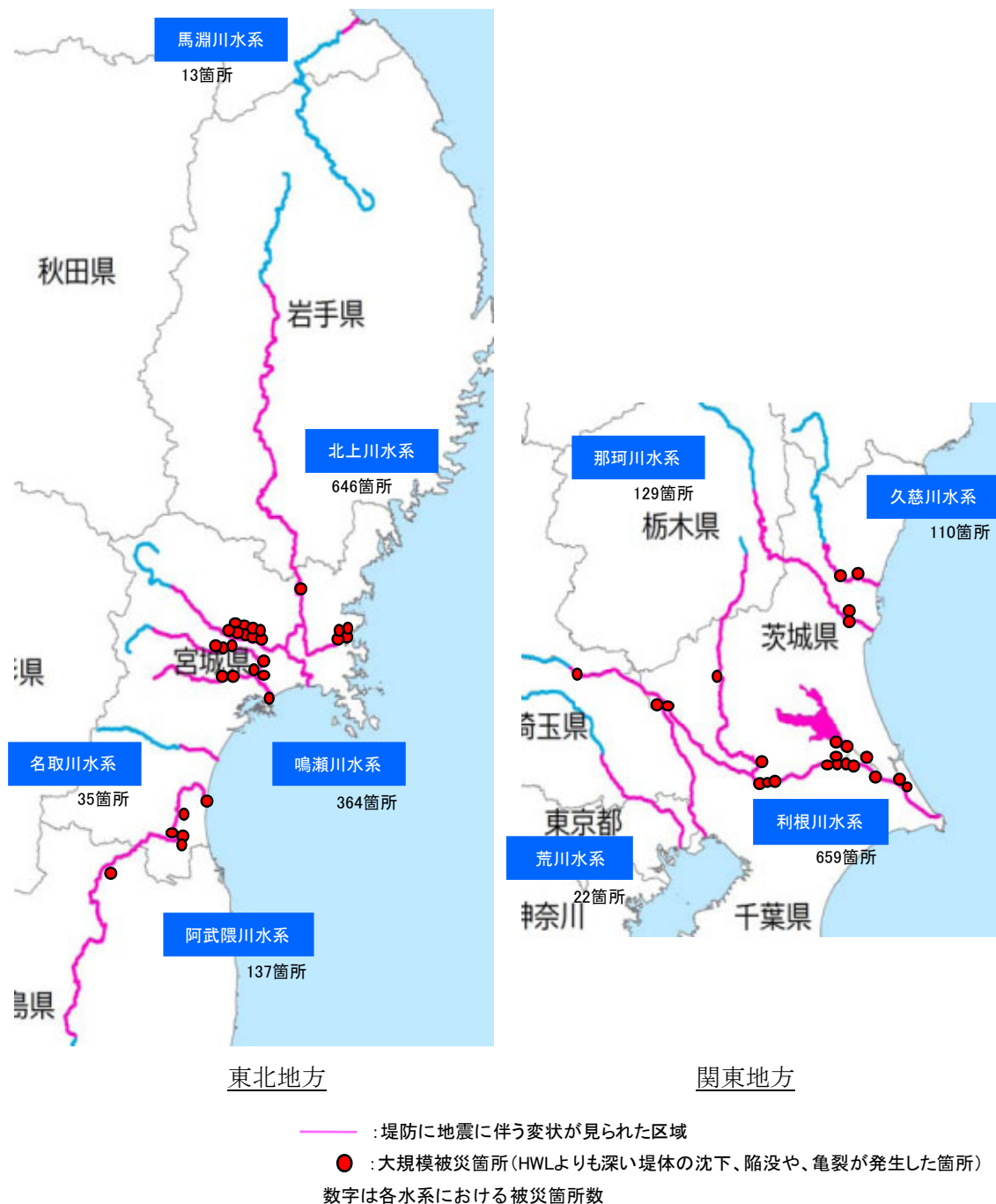
図-6 東日本大震災における堤防の被災区域、被災箇所数
