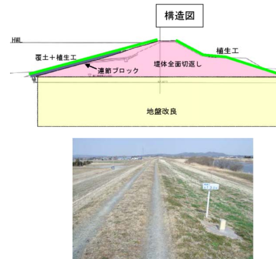
今回の地震後の状況(対策工部に変状なし)
