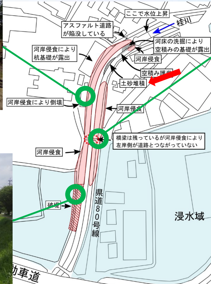
橋梁の左岸取り付け部が侵食され、橋脚も傾倒。
