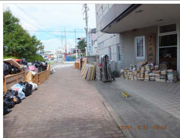
j. 地点 i から県道 55 号線に出た地点。周辺の状況から床下浸水程度と推定されるが, 一階のフロアが周辺地盤とほぼ同じ施設では 1 階にあった家財が被害にあったようである。
