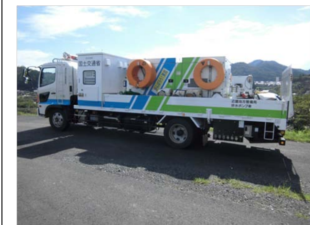
3) 排水機場脇の由良川堤防天端で待機する排水ポンプ車
