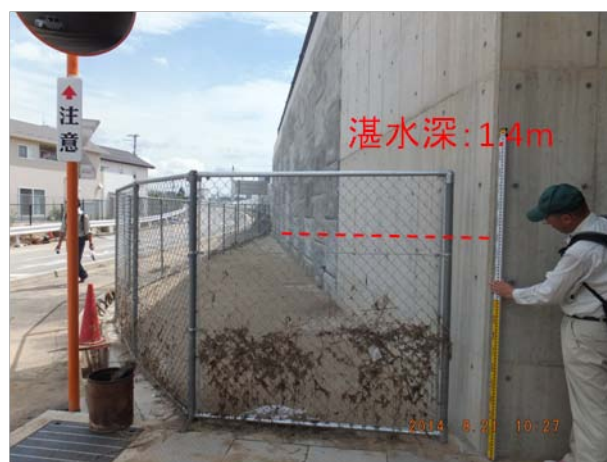
p. 一宮神社近くの国道9号線のアンダーパスに残る浸水痕跡
