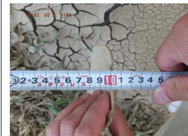
i. 荒河地区の農道脇に堆積した泥。厚さは 3mm 程度。
