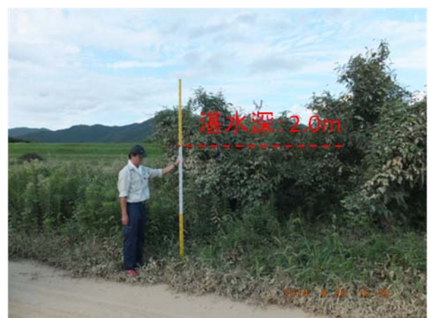
j. 和久川近傍の農道で確認した浸水痕跡
