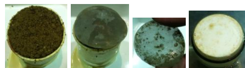
ペDESTALおよびフィルター、供試体上端部分
