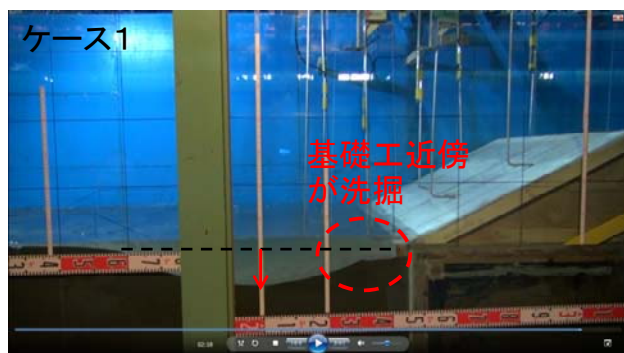
写真-3 越流後の地形（ケース 1）
