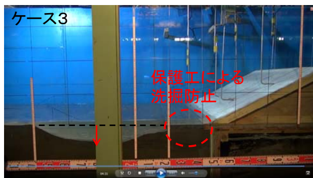
写真-4 越流後の地形（ケース 3）
