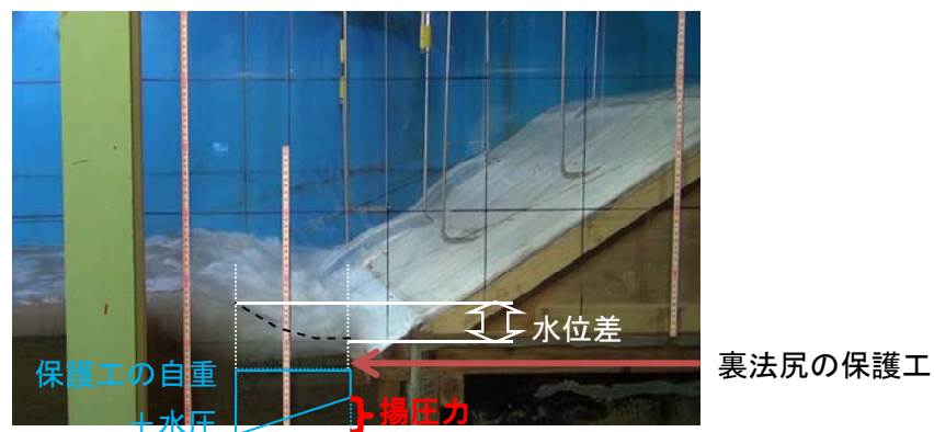
写真-6 跳水に伴う水位差による揚圧力
