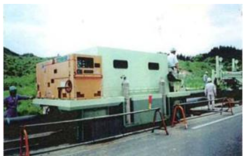
(4) パイプ工作車(芯出し・TIG 溶接車)
