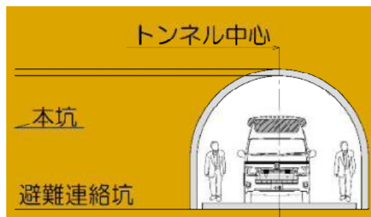
図 8.17 避難坑の検討断面（将来拡幅無）
