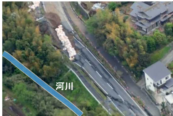
写真-1 国道443号の盛土崩壊全景
