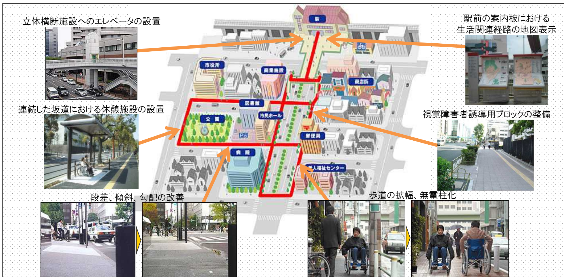
重点整備地区における道路のバリアフリー化のイメージ
