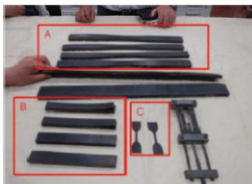
A:ゴム引布引張強さ試験片 B:接着力試験片 C:ゴム初期物性試験片
