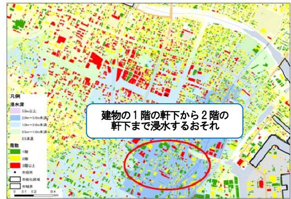
図-6 洪水に伴う浸水深と建物の階層に関する情報との重ね合わせ
