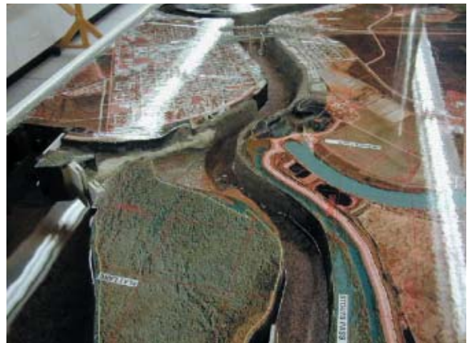
写真二 分合流モデル（河床材料の敷設深は10cm程度、河道法面は粘土などで微妙な形状を再現している）
