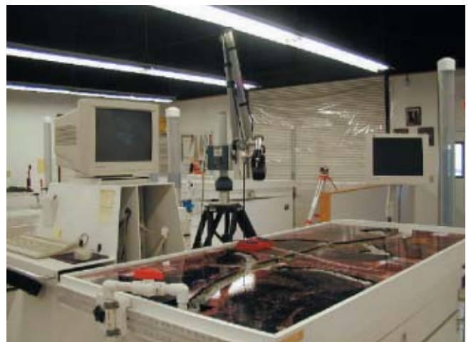
写真三 河床形状計測用の3次元レーザーセンサー
