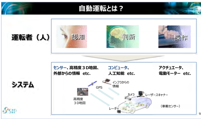
図6 自動運転では認知・判断・操作をシステムが行う
