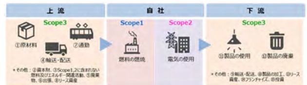
図 5 中部地方整備局試行工事における CO 2 排出量算出対象
